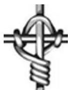
Le nœud TIGHT permet une meilleure liaison entre les fils horizontaux et verticaux. Grâce à ce nœud, les fils verticaux sont continus, cela permet une meilleure dissipation des impacts. C'est un nœud solide, cependant le Clovix est 24% plus résistant.
