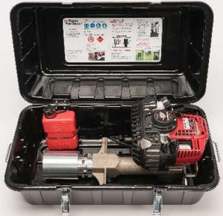
*Machine permettant l'enfoncement de pieux jusque 10 cm de diamètre. Convient pour tous les types de piquets (fers, bois, plastiques,...). Le prix inclus l'enfonce pieux thermique, sa boîte de rangement, son bidon d'essence ainsi que 3 adaptateurs pour piquets ronds (107 mm, 85 mm et 56 mm). Machine professionnelle composé d'un légendaire moteur Honda GX 35 à 4 temps.*
