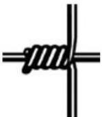
Le nœud HINGE JOINT est le plus répandu dans les solutions de grillages d'élevage. C'est le nœud le plus économique, et un grillage idéal pour les animaux sans velléités de fuite (anatisés, ovins, camélidés). Il n'est pas conçu pour résister aux impacts et n'est pas adapté aux animaux sauvages ou percutants. **A éviter pour la faune sauvage.**
