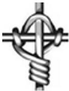
Le nœud TIGHT permet une meilleure liaison entre les fils horizontaux et verticaux. Grâce à ce nœud, les fils verticaux sont continus, cela permet une meilleure dissipation des impacts. C'est un nœud très solide.
