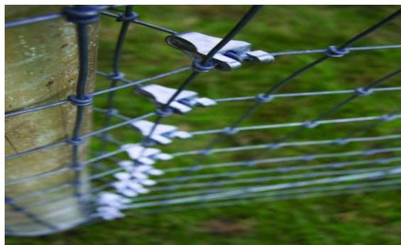
*La gamme Gripple Plus permet le raboutage, la tension et la réparation de fils, en éliminant le besoin de les nouer entre eux. Le système breveté avec rouleaux en céramique maintient le fil de fer sous tension, tout en permettant d'appliquer une tension supplémentaire à tout moment.*
